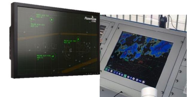
Immer mehr Flugzeuge der General Aviation, Segelflugzeuge, Helikopter und UAVs senden ihre Position, Flughöhe, Geschwindigkeit, Steig-/Sinkrate mittels ADS-B oder FLARM-Transponder.
